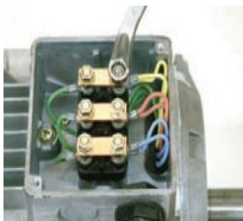
نحوه اتصال مثلث در درون تخته کلم موتور
